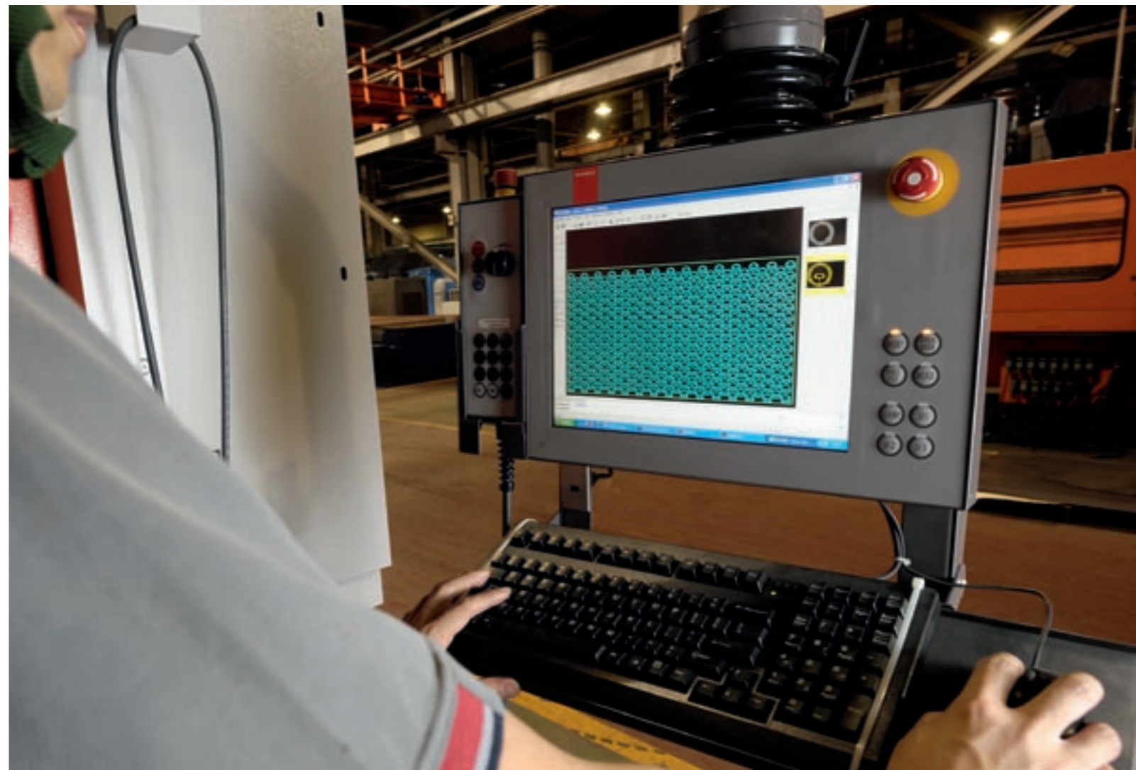
上圖：Bystronic Bystar L 4025 65M的切割範圍為6.5x2.5米，雷射功率為6千瓦。這是處理較大和較厚板材的完美解決方案。由於性能極高、操作方便，所以Bystronic之雷射切割系統易於操作。
