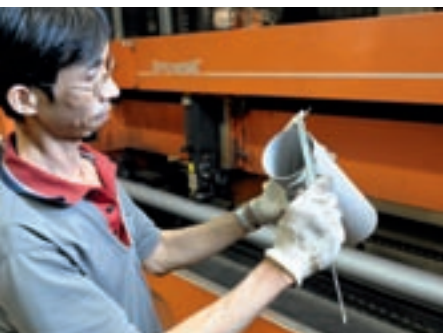
精密管材切割：此機器可用於製作攝影機的攝影鏡頭。它由Bystronic雷射切割系統切割。這個靈活的設備可選配一個用於加工管材和剖面的旋轉軸。
